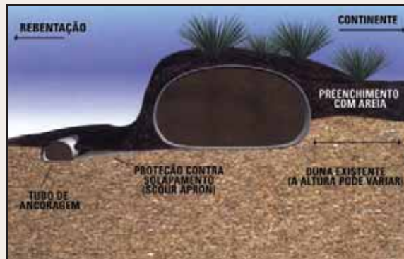
Seção transversal de duna de areia com núcleo de Geotube®.
