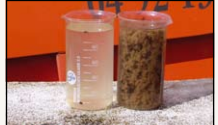
Quello che entra e quello che esce dal TenCate Geotube® in un impianto di depurazione reflui
